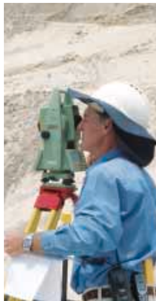
A droite: Le géomètre-topographe Rod Stead, de Treasure & Associates, surveille le chantier Q1 avec un tachéomètre Leica TCR1101.
