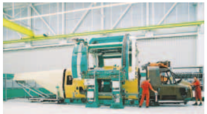
Eurocopter souhaitait réaliser les mesures dans la chaîne de fabrication pour ne pas avoir à retirer l'outil et le déplacer jusqu'au poste de contrôle fixe.
